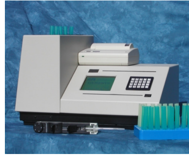
Şekil 10. Radioimmunoassay'in prensibi ve Gama sayacı
